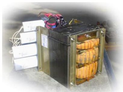
شکل شماره ۸-۵: ترانسفورمر
